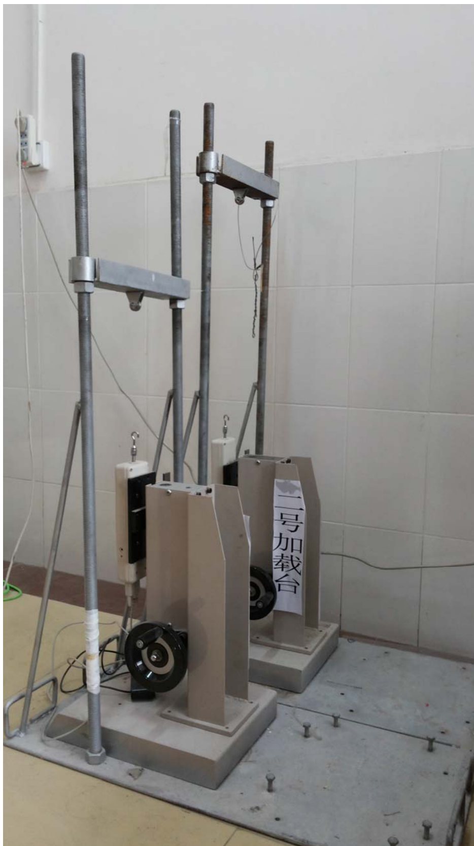
海南省第三届大学生结构设计竞赛加载工具 (学生参与下的创造性设计，已申报国家发明专利)
